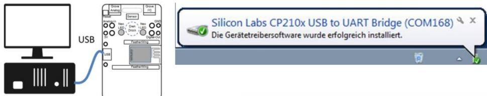
Das Betriebssystem des PCs sollte das USB-Interface automatisch erkennen und einen virtuellen COM-Port vergeben. Die Nummer des COM-Ports merken wir uns. Haben wir die Windows-Meldung verpasst, so können wir den Port im Gerätemanager unter Anschlüsse als Silicon Labs CP210x identifizieren<sup>1</sup>.
