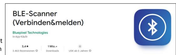
Wenn der Raspi die drei Befehle ausgeführt hat, müsste jetzt die (im Playstore angebotene) BLE-Scanner-App die Beacon-Information so wie auf dem Bild links anzeigen. Der Raspi war ca. 16 cm vom Smartphone entfernt und dieses reagierte auf das Tippen auf "OPEN URL" mit dem Laden der Seite "[www.Speyer.de](http://www.Speyer.de)" in den Smartphone-Browser.
