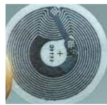
Hier sollte das **NFC-Tag für die Seite mit dem Videostream** aufgeklebt sein:
