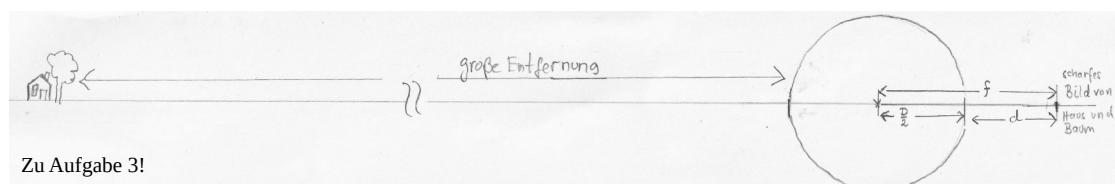
3. Bestimme den Abstand des scharfen Bild hinter den Kugel - von der Kugeloberfläche gemessen - wenn die Szene vor der Kugel weit entfernt ist. Wir kürzen diesen Abstand mit d ab. Berechne außerdem, wie weit das Bild vom Mittelpunkt der Kugel entfernt ist. Dieser berechnete Abstand  $D/2+d$  ist die Brennweite der Kugellinse, abgekürzt mit f.
