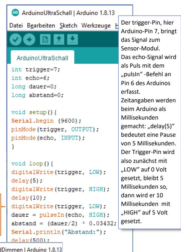
Der trigger-Pin, hier Arduino-Pin 7, bringt das Signal zum Sensor-Modul. Das echo-Signal wird als Puls mit dem „pulseIn“ -Befehl an Pin 6 des Arduinos erfasst. Zeitangaben werden beim Arduino als Millisekunden gemacht: „delay(5)“ bedeutet eine Pause von 5 Millisekunden. Der Trigger-Pin wird also zunächst mit „LOW“ auf 0 Volt gesetzt, bleibt 5 Millisekunden so, dann wird er 10 Millisekunden mit „HIGH“ auf 5 Volt gesetzt.
