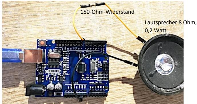
Über den digitalen Pin 8 werden - gesteuert durch den Sketch „ArduinoNurSound“ - Frequenzen von 50 bis 4000 Hertz an den einen Anschluss des Lautsprecher gegeben. Ein 150-Ohm-Widerstand in der Zuleitung begrenzt die Stromstärke und stellt die Lautstärke ein. Der zweite Anschluss des Lautsprechers wird an einen GND-Pin angeschlossen. Zur Soundausgabe kann auch ein passiver Piezo-Lautsprecher („Buzzer“) gewählt werden.
