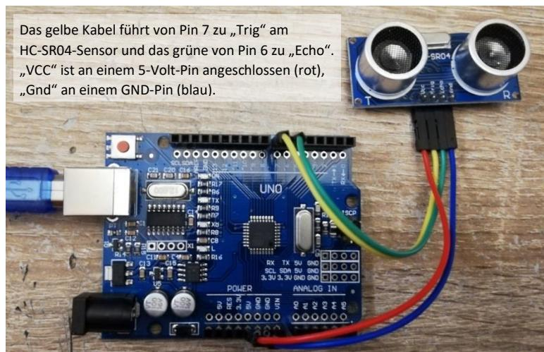
Oben siehst du, wie der Abstandssensor (Modell HC-SR04) an den Arduino angeschlossen werden muss, rechts den Sketch (das Programm), das über die Arduino-Entwicklungsumgebung hochgeladen werden muss.
